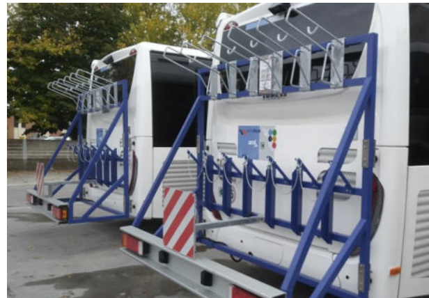
Figura 128 Sistemi per il trasporto di biciclette per autobus [Fonte: Azienda X-metal]
