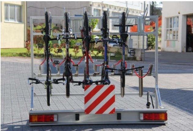
Figura 128 Sistemi per il trasporto di biciclette per autobus [Fonte: Azienda X-metal]
