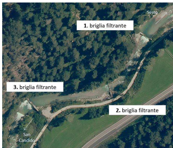
Figura 8. Le briglie filtranti esistenti lungo il Rio di Sesto nel sito di diversione delle piene.
