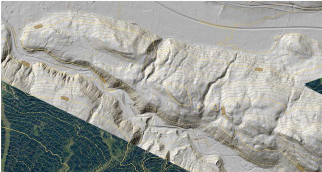
**Figura 124.** Curve di livello e DTM 0,5 m sfumato per l'area estesa di progetto.
