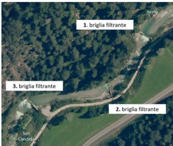
**Figura 17. Le briglie filtranti esistenti lungo il Rio di Sesto nel sito di diversione delle piene.**
