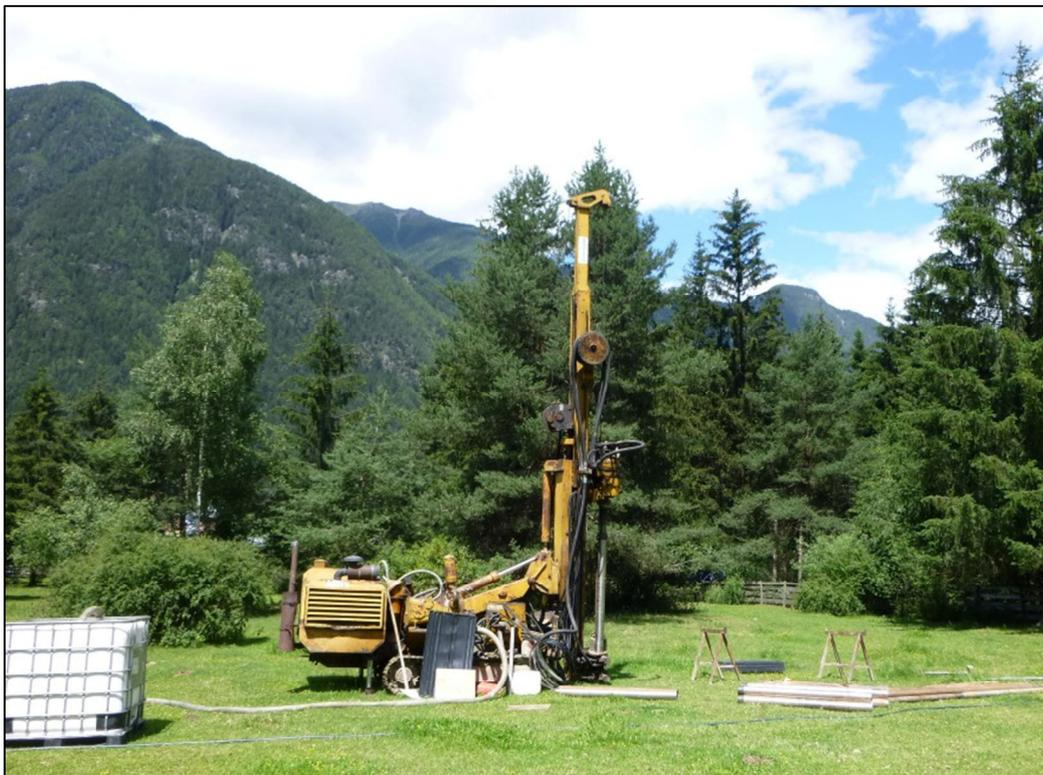
Figura 1 - Perforatrice idraulica Puntel PX600.
