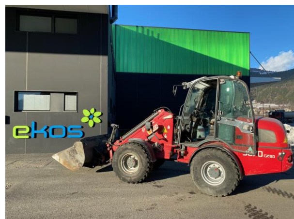
Abb. 9: Teleskopradlader der ekos GmbH für die Vermengung und Vermischung von Abfällen
