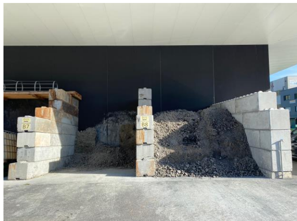
Abb. 5: Abfallbunker mit Schlamm EAK190205 aus der Abfallzwischenlagerung (D15) von ekos
