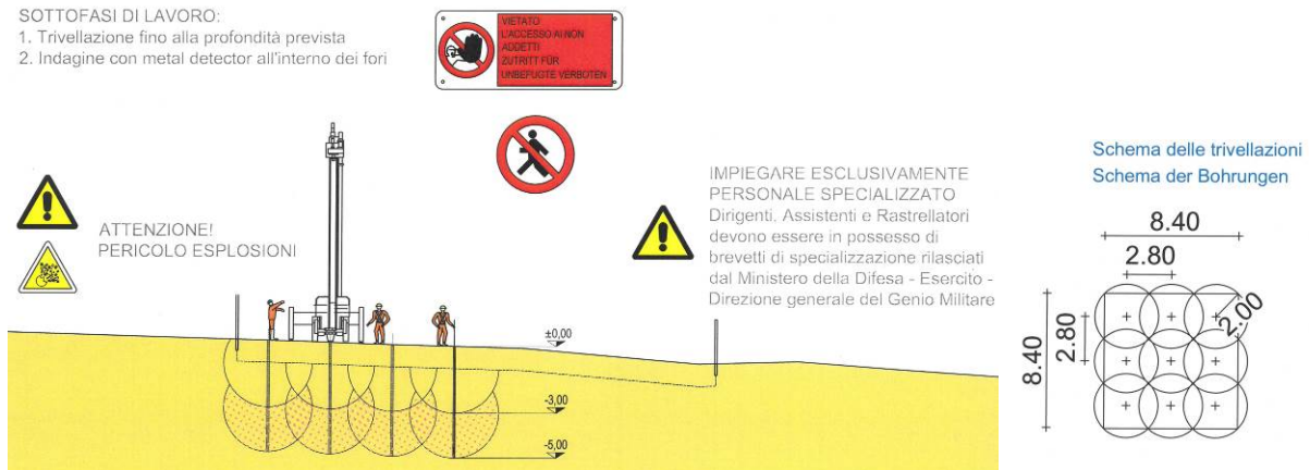
Abbildung 3: Schema Beseitigung von Kriegsrelikten bis 5 m
