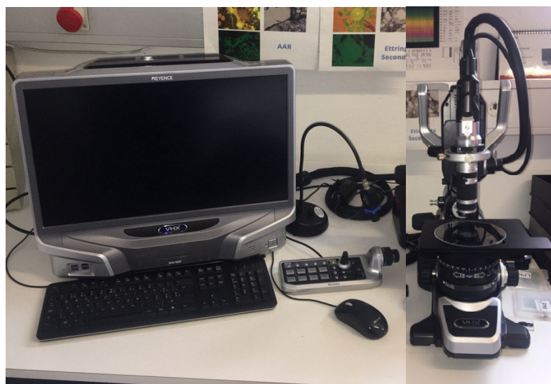
Figura 5. Sx: schermo HD per l'analisi d'immagine - Dx: microscopio e fotocamera HD
