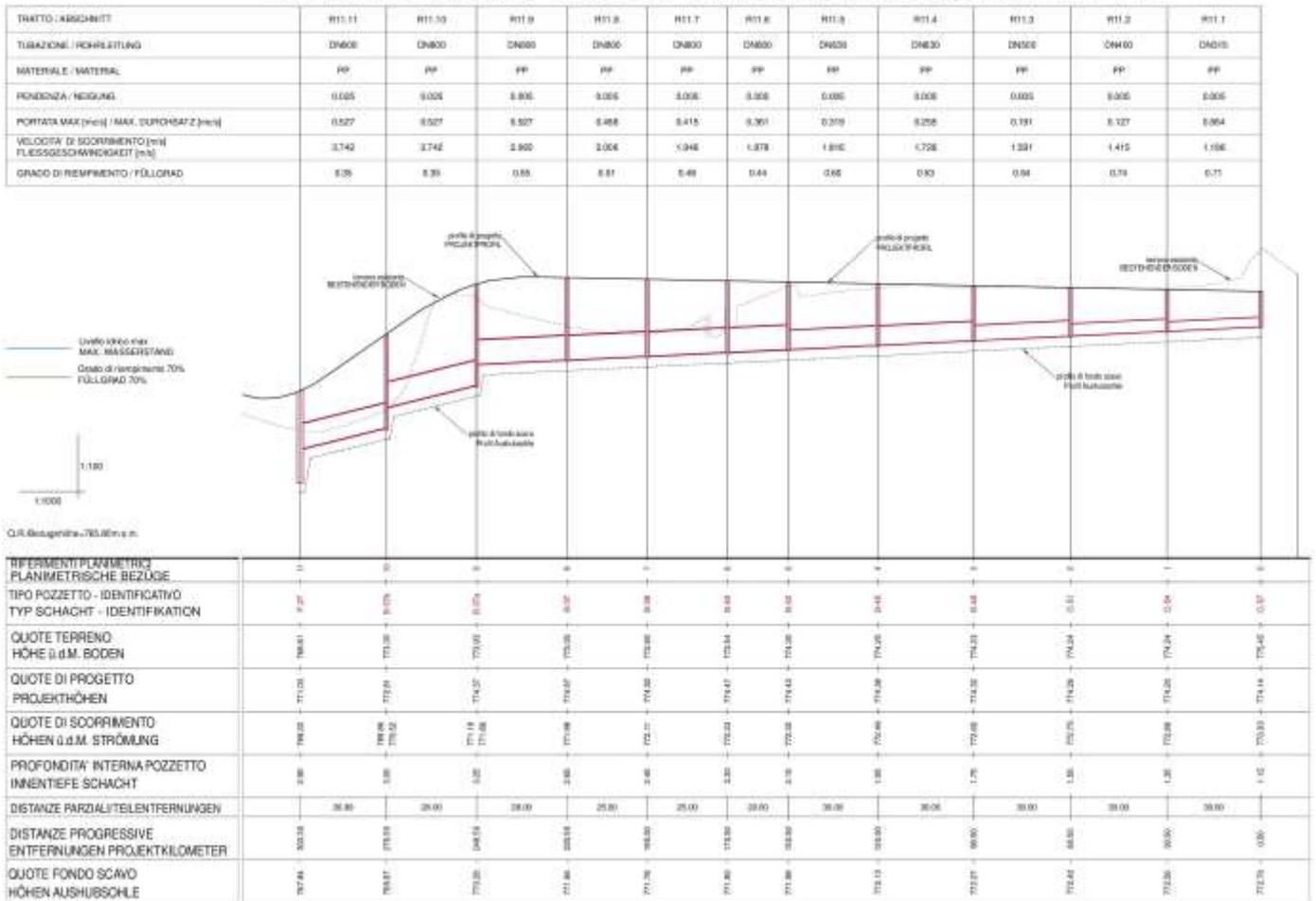
Partendo dalle portate definite in Progetto e richiamate nel capitolo precedente, sono state ricalcolate le portate per ciascun tratto del collettore R11 ed eseguite le verifiche idrauliche, i cui risultati sono riportati nel profilo della figura precedente e nella tabella seguente.
