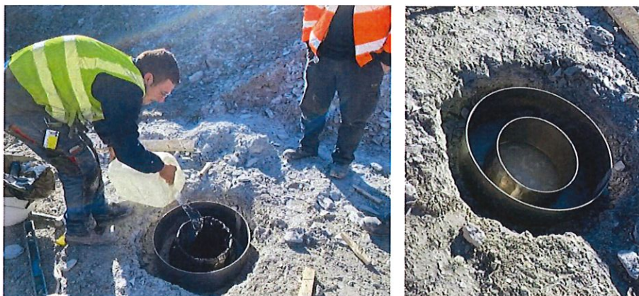
Figura 4. Riempimento anello centrale con volume noto e misura degli abbassamenti nel tempo.
