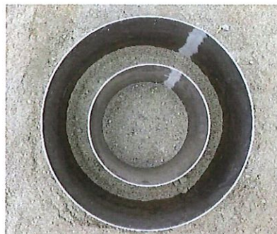
Figura 2. Infiltrometro a doppio anello.
