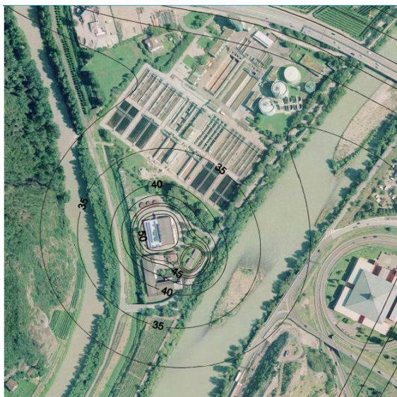
Lärmausbreitung ausgehend von der Fernheizentrale:
