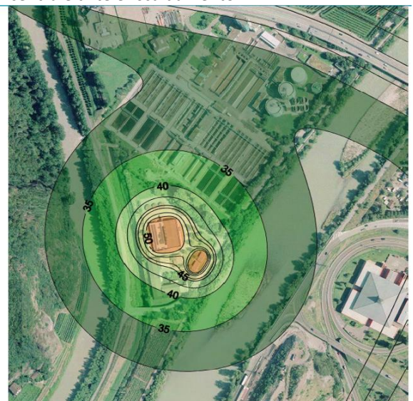
propagazione della emissione acustica della centrale di teleriscaldamento:
