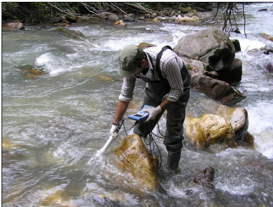
Foto 2.7 – Sonda multiparametrica per il rilevamento in situ dei parametri chimico-fisici in ST_1 (Foto Bioprogramm, 2013)
