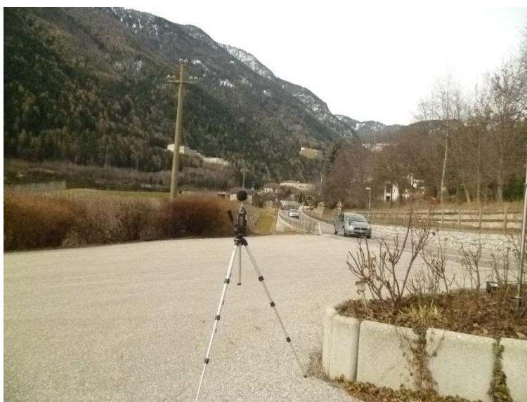
Figura 2: fonometro posizionato nel parcheggio della pensione Klammerhof per la taratura del modello
