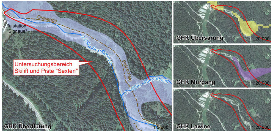
Abbildung 9.2: Auszug aus den Gefahrenhinweiskarten der Provinz (Hazardbrowser) im unteren Abschnitt des geplanten Skiwegs „Sexten“
