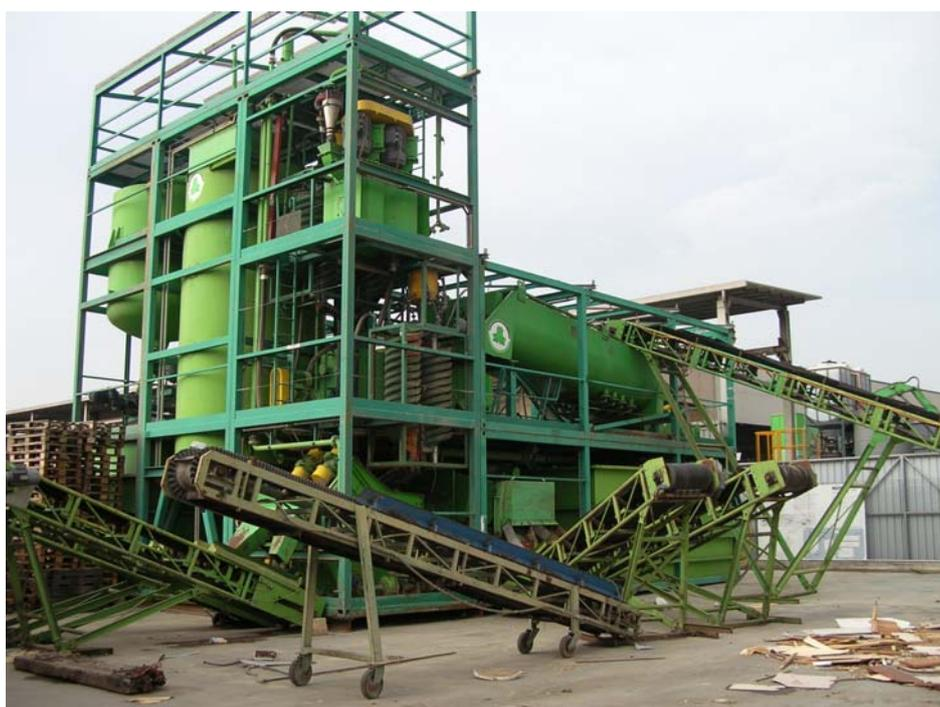
**Figura 9 - Impianto mobile di lavaggio.**
