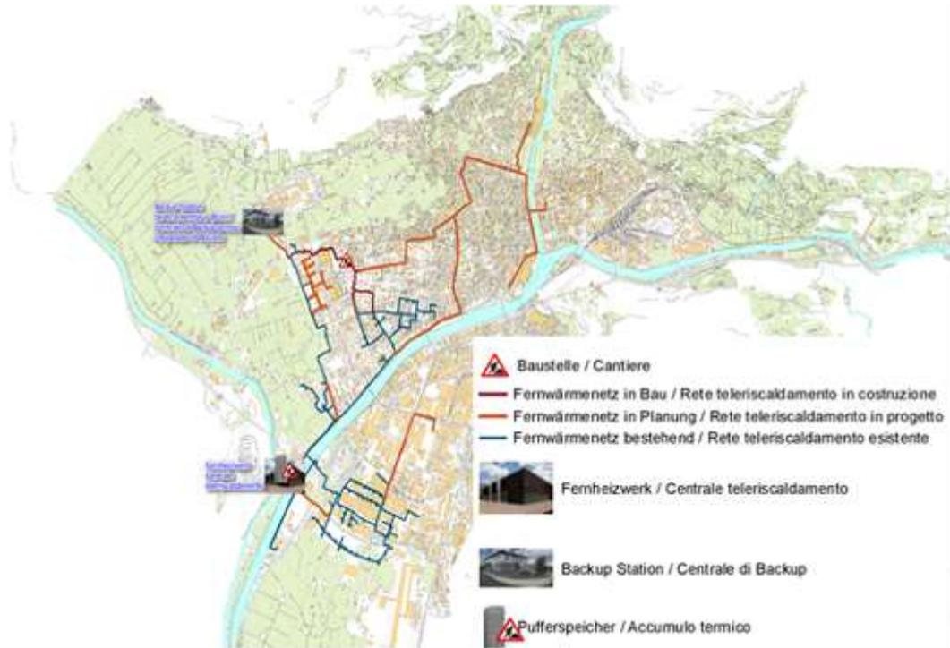
Figura 87: Mappa della rete di teleriscaldamento prevista (fonte: mappa SEL S.p.A.)
