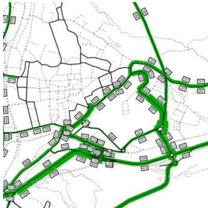
Figura 60: Simulazione dei flussi di traffico stradale 2020 con la presenza delle due circonvallazioni (variante Est con tunnel del Monte Tondo e variante Sud SS12)
