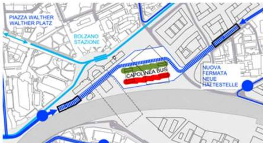
Figura 66: Estratto della viabilità pubblica per percorso interrato di progetto dei BUS
