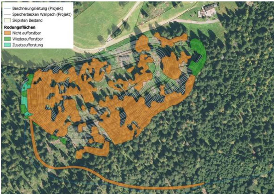
Rodungs- und Aufforstungsflächen im Baubereich des Speicherbeckens
