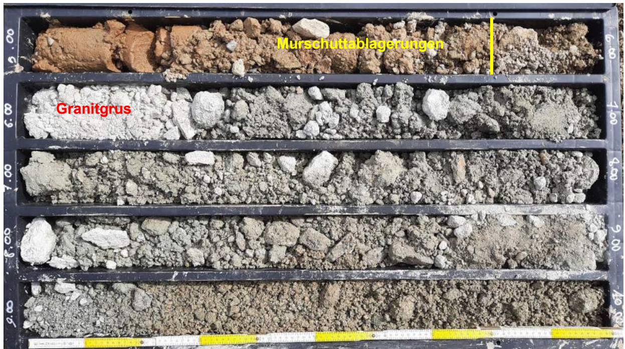
Abb. 2 Bohrung S1 – Kernabschnitt 5-10 m; die gelbe Linie bei Bohrmeter 2,8 markiert die Schichtgrenze zwischen den Murschuttablagerungen und dem verwitterten Granit.
