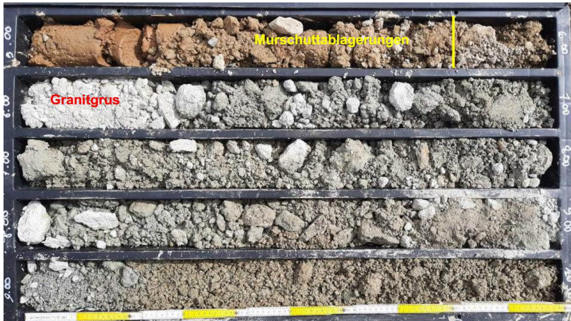
Abbildung 6.8: Bohrung S1 – Kernabschnitt 5-10 m; die gelbe Linie bei Bohrmeter 2,8 markiert die Schichtgrenze zwischen den Murschuttablagerungen und dem verwitterten Granit.
