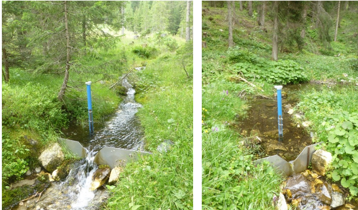
Abb. 5-5: Wehre und Abfluss-Messstation unterhalb Quelle 605 (links) und Quelle 606 (rechts)
