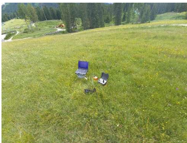
Stazione HVSR2 in fase di installazione.
