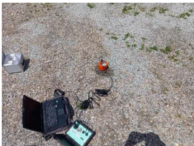
Stazione HVSR1 in fase di installazione.
