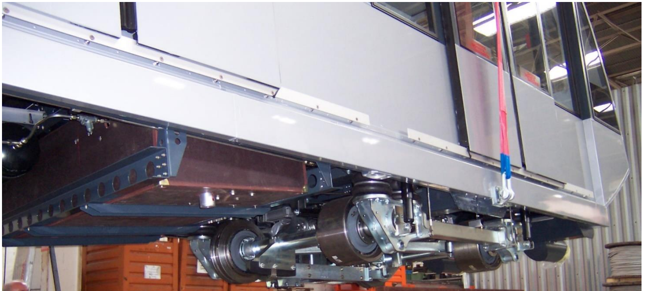
Bild 1: Drehgestell mit Spur- und Walzrad und Luftkissenfederung
