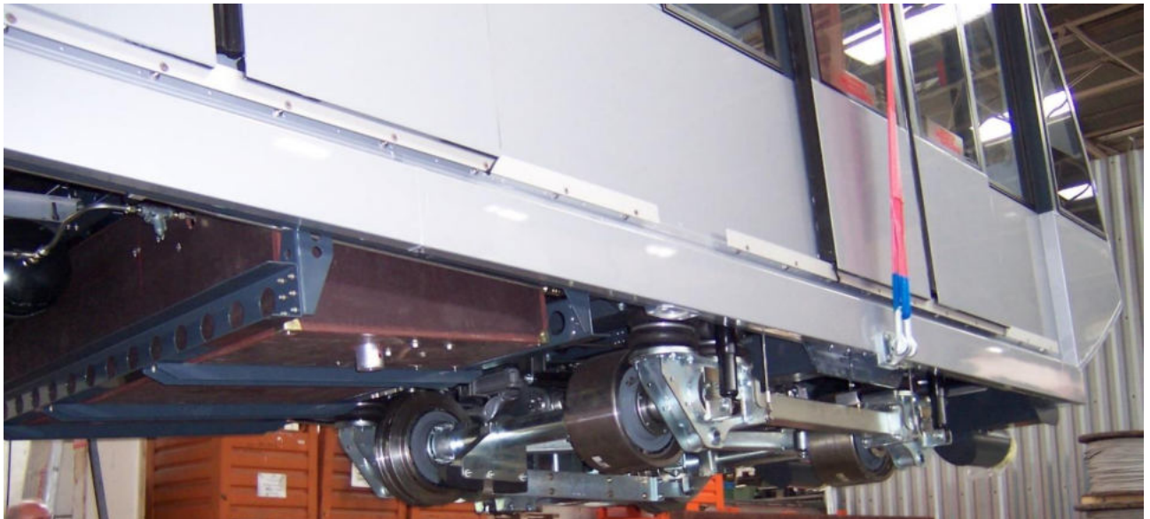
Bild 1: Drehgestell mit Spur- und Walzrad und Luftkissenfederung
