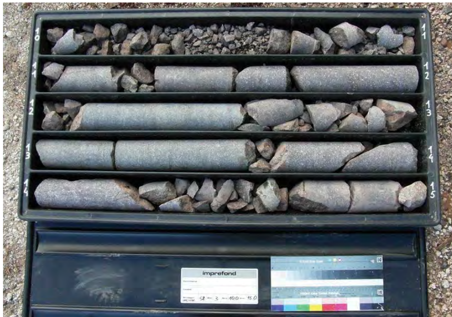
Figura 7 – Cassetta catalogatrice – carotaggio in roccia
