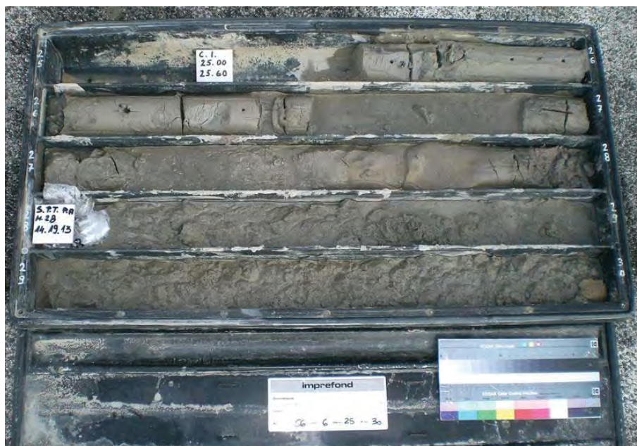
Figura 6 – Cassetta catalogatrice - carotaggio in terreni
