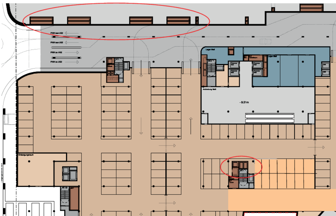
Figura 71: pozzi di ventilazione sulla parte esterna dell'edificio e lo scarico per il fumo con alberi al centro dell'edificio
