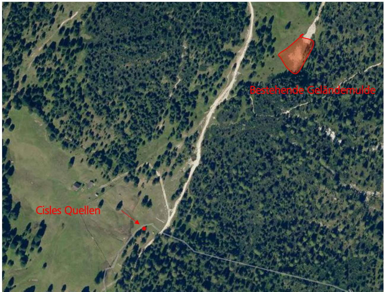
Abb. 11: Trinkwasserquellen Cisles mit darüberliegender Geländemulde, wo sich bei Starkregen ein Teich mit Feinstoffablagerung bildet, welche mit großer Wahrscheinlichkeit die Ursache für die Trübung des Quellwassers sind
