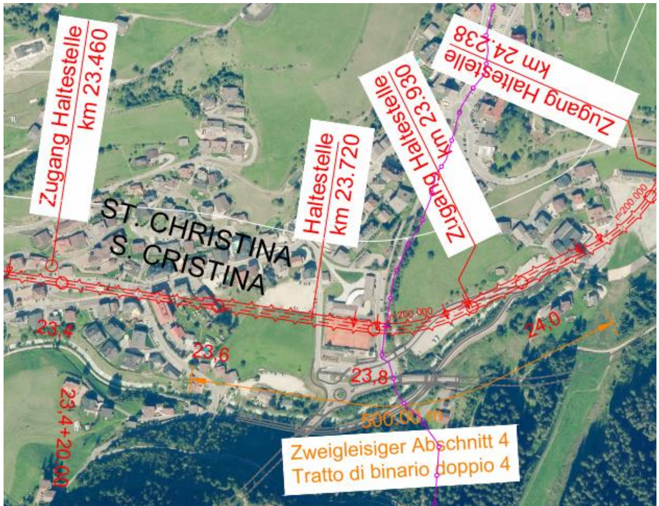
Abb. 4: Auszug aus der vorliegenden Trassierung der „Neuen Grödner Bahn“ mit der geplanten Haltestelle in der Sperrzone Iman wo die Talstation der Standseilbahn geplant ist.
