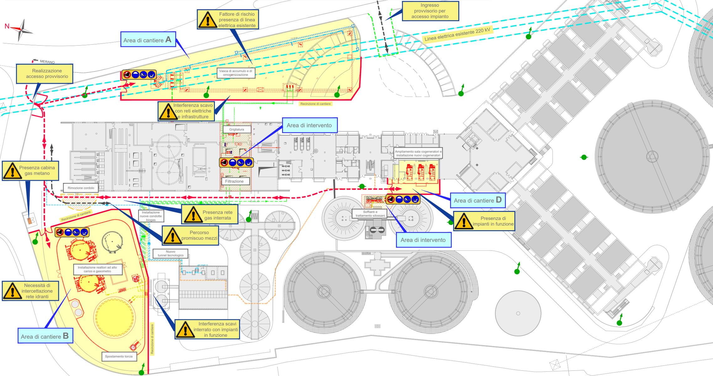
PLANIMETRIA CON AREE DI CANTIERE E VIABILITÀ DI ACCESSO (Scala 1:500)
