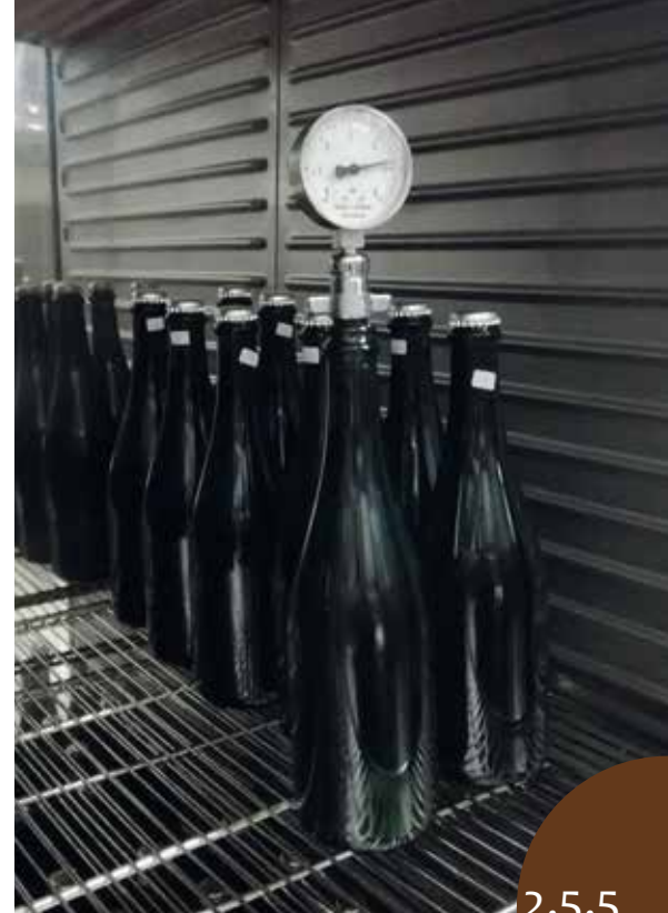
Abb. 1: Apfel-Cidre während der Flaschengärung. Eine Flasche ist mit einem Aphrometer ausgestattet, um den Druckanstieg aufgrund der Kohlendioxidentwicklung zu überwachen.
