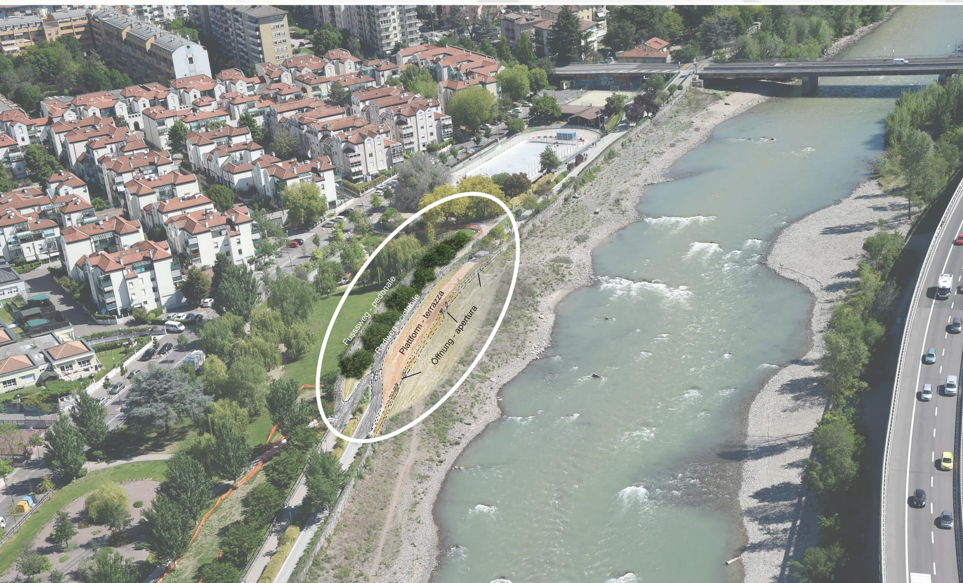
Bau einer Plattform um eine direkte Verbindung vom Park zum Fluss zu ermöglichen. Die Maßnahme erstreckt sich auf einer Länge von 120m und einer maximalen Breite von 20m. Dafür ist es notwendig den Fußgänger- und Fahrradweg in Richtung Park zu verlegen. Es werden zwei Fußgängerübergänge und an drei Stellen werden mittels Abbruch der Ufermauer auf einer Länge von 5m Zugänge zum Fluss errichtet.
