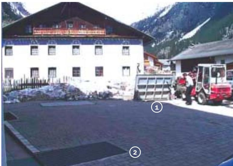
Abb. 15 Beschickung (1) und Lüftung (2) in angemessenem Abstand zum Gebäude - richtige Lösung
