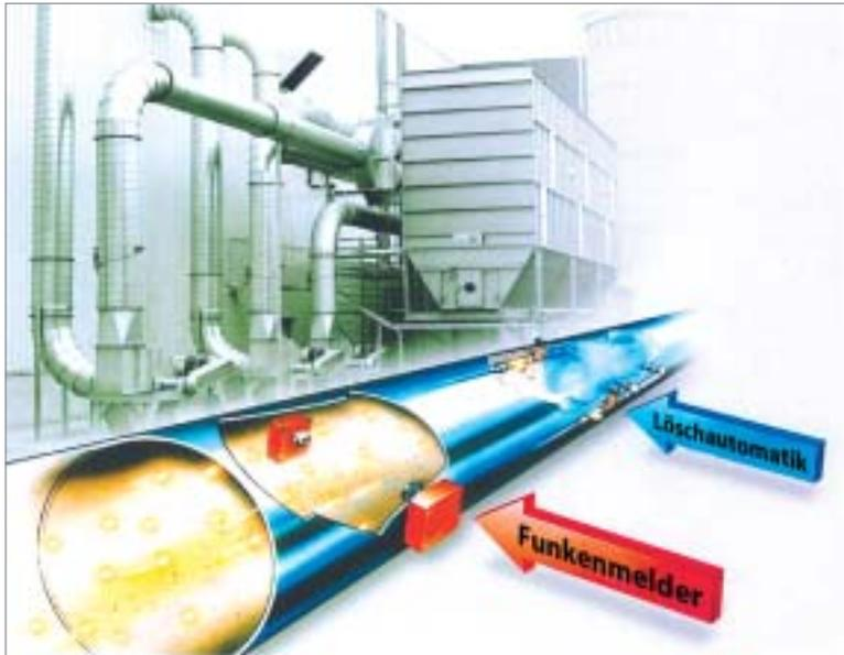
Abb. 13 Funktionsprinzip einer Funkenerkennungs- und Löschanlage
